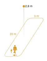
Mögliche Montagehöhe: 2,50 m – 3,50 m Orange: radial und tangential Dimension Drawing
